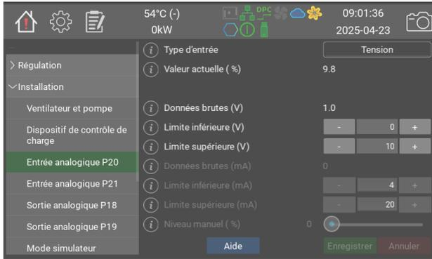
Les entrées analogiques peuvent être utilisées pour commander le point de consigne de température, la limitation de puissance, la puissance DPC, etc.
