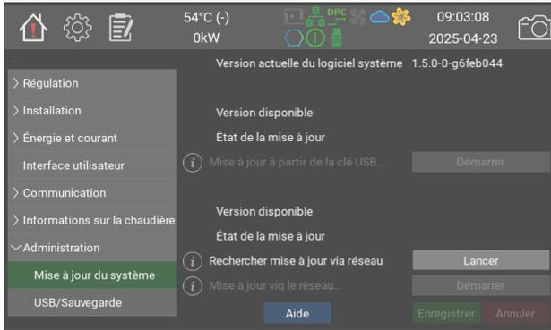
Le logiciel de la chaudière peut être mis à jour à partir d'une clé USB ou directement à partir du serveur de Värmebaronen.
