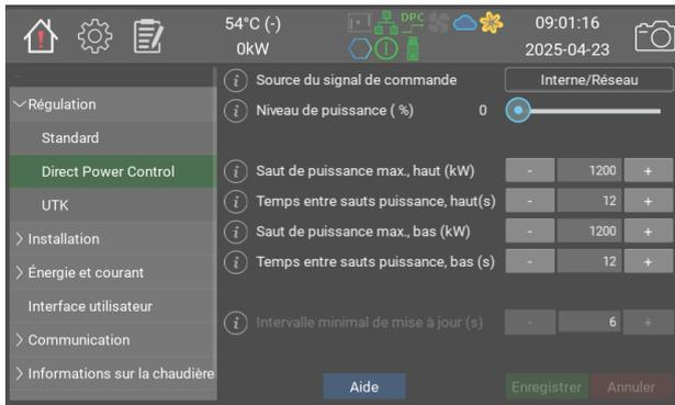
DPC permet une commande directe de la puissance à partir d'un système de contrôle supérieur. Dans ce mode, la régulation interne de température est désactivée. La protection contre la surchauffe, la puissance max. définie et la limitation externe de puissance restent actives.
