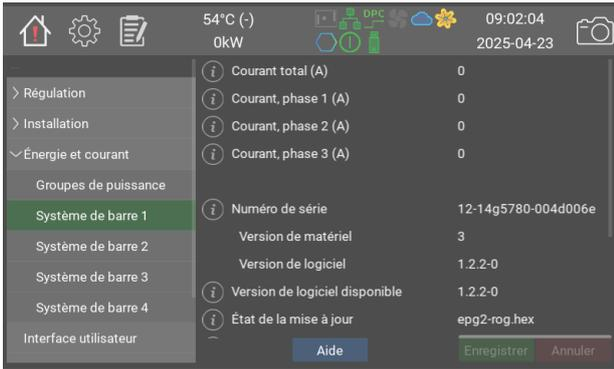
Chaque système de barre comporte une carte de mesure du courant. Cette carte mesure les courants de phase et le déséquilibre éventuel entre les phases. En utilisant les courants de phase
