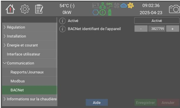
Avec l'option BACNet, la chaudière peut être contrôlée et surveillée via BACNet IP.
