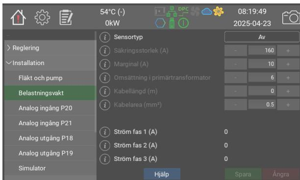
Belastningsvakten används för att skydda huvudsäkringarna i de fall pannan delar dessa med andra apparater. Pannan mäter kontinuerligt strömmen vid centralen och anpassar sin effekt så att den alltid ligger under angiven säkringsstorlek minus marginal.
