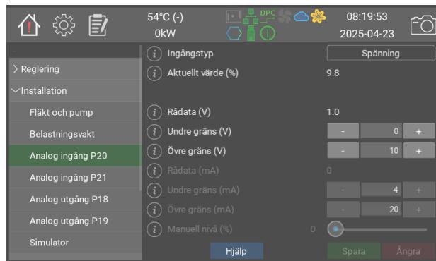
De analog ingångarna kan användas till att styra temperturbörvärde, effektbegränsning, DPC effekt mm.
