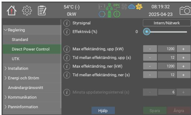
DPC möjliggör direkt effektstyrning från ett överordnat kontrollsysteem. I detta läge är den interna temperaturregleringen avstängd. Överhetningsskydd, max installerad effekt och eventuell extern effektbegränsning gäller.
