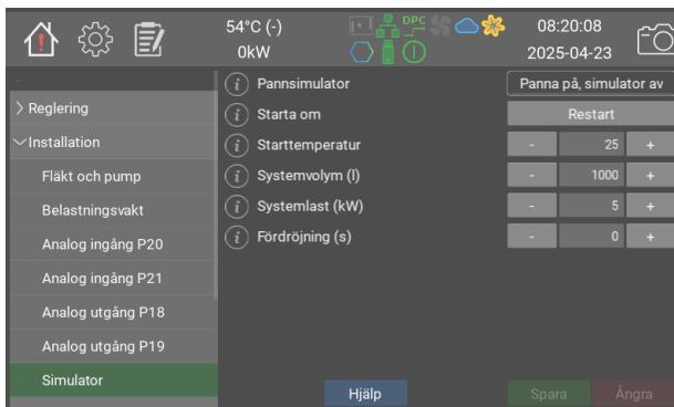
Simulatorn kan användas för demo eller för att testa in- och utgångssignaler innan pannan sätts i driftläge.
