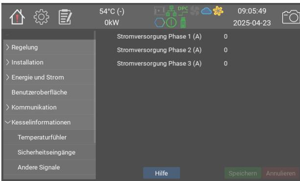
Diese Seite zeigt den Stromversorgung/ die Phase an den Sicherungen, die der Lasttrennschalter schützt. Die korrekte Anzeige erfordert, dass alle Einstellungen des Lastwächters ordnungsgemäß ausgeführt und angepasst werden. Informationen zur Einstellung des Lastwächters sind dem Abschnitt Lastwächter im Handbuch Menüs und Steuersystem von EP G2 zu entnehmen.
