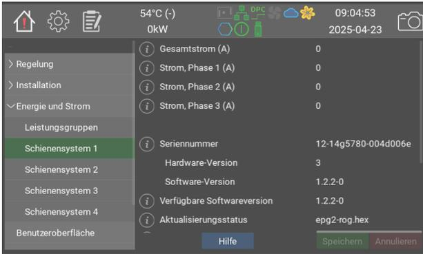
Anhand der gemessenen Phasenströme und des Widerstands in den Heizstäben wird die Stromleistung berechnet und auf der Seite Energie und Strom dargestellt.
