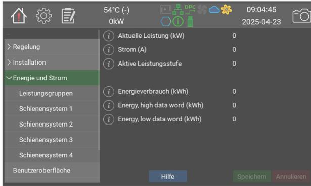
Hier wird die aktuelle Gesamtleistung in kW, Gesamtstrom und Leistungsstufe angezeigt.
