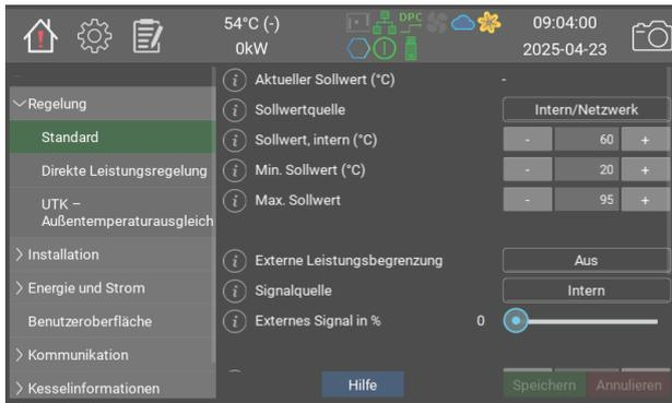
Im Standardmodus besteht das Ziel darin, die Kesseltemperatur möglichst nah am Sollwert zu halten. Die Kesselregelung funktioniert am besten, wenn sie frei zwischen verfügbaren
