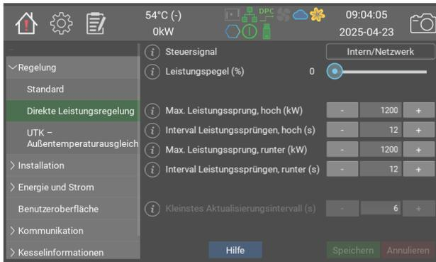
DPC ermöglicht die direkte Leistungssteuerung über ein übergeordnetes Steuerungssystem. In diesem Modus ist die interne Temperaturregelung ausgeschaltet. Überhitzungsschutz, maximale installierte Leistung und eine eventuelle externe Leistungsbegrenzung gelten.
