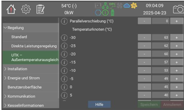
Die Funktion für den Außentemperatenausgleich passt den Sollwert an die Außentemperatur an. Ein Sensor für den Außentemperatenausgleich muss an P13 angeschlossen werden. Der Außentemperatenausgleich wird durch Auswahl von **UTK** als **Sollwertquelle** auf der Steuerungsseite aktiviert.
