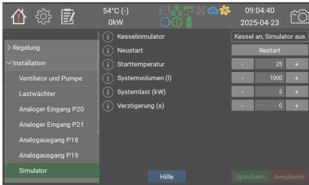
Der Simulator kann zu Demo- oder Testzwecken für Eingangs- und Ausgangssignale verwendet werden, bevor der Kessel in den Betriebsmodus versetzt wird.
