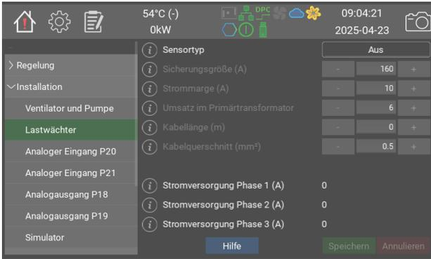
Der Lasttrennschalter dient zum Schutz der Hauptsicherungen in Fällen, in denen der Kessel diese mit anderen Geräten teilt. Der Kessel misst kontinuierlich den Strom am Schaltschrank und passt seine Leistung so an, dass er immer unter der angegebenen Sicherungsgröße abzüglich der Strommarge liegt.
