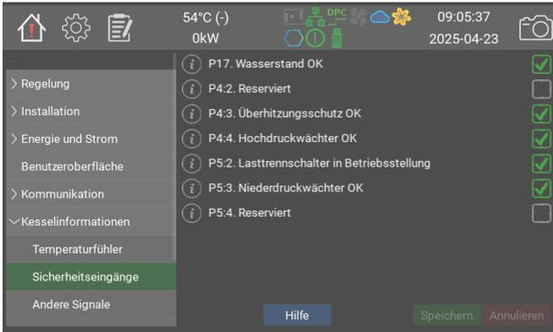
Status der sicherheitsrelevanten Eingänge. P4 und P5 werden auch auf dem Leistungsmodul angezeigt.
