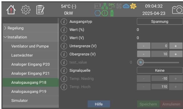
Ausgangsspannung, 0–10 V, ist proportional zum ausgewählten Wert.
