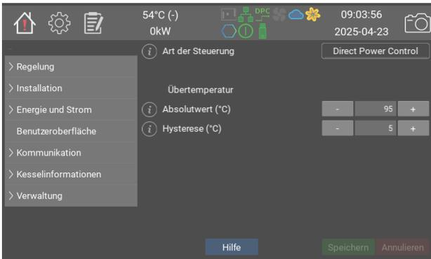
Der Übertemperaturschutz des Kessels sollte so eingestellt werden, dass er auslöst, wenn die Temperatur einige Grade unter dem externen Überhitzungsschutz liegt.
