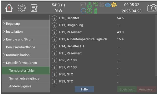
Diese Seite zeigt die aktuellen Werte für alle angeschlossenen Temperatursensoren an.
